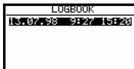
Die Flüge sind mit AUF/AB Drehschalter auswählbar und nach ENTER erfolgt die Flugstatistik.
